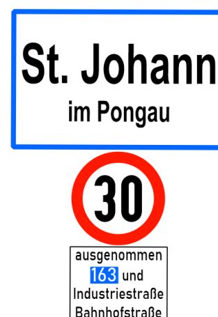
Abb. 6: Kundmachung Geschwindigkeitsbeschränkung 30 km/h in Verbindung mit der Ortstafel St. Johann im Pongau inkl. Zusatztafel mit Angabe der Ausnahmen
